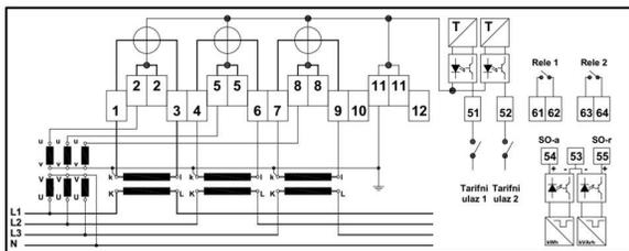
Šema povezivanja brojila nalazi se sa unutrašnje strane providnog poklopca priključnog dela brojila.
